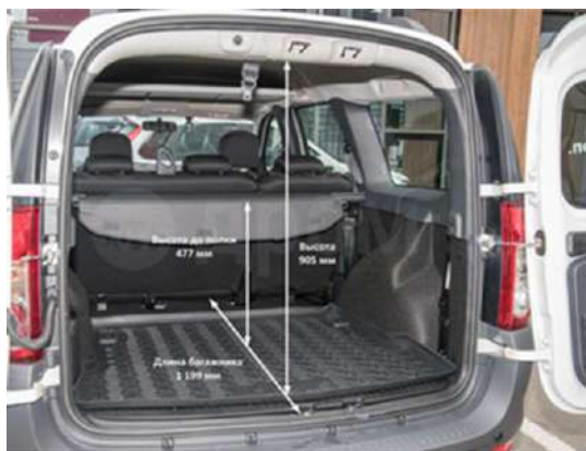
Рисунок 5. Размеры багажника «Лада Ларгус»
